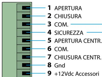
Nel caso di sicurezze non installate ponticellare i morsetti 3 e 4
