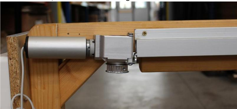
Ziehen Sie nun die Madenschrauben an, um sie fest mit der Schiene zu verbinden:
