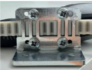
Spannen Sie den Riemen weiter, indem Sie ihn durch die Riemenscheibe (A) des Bandumlenkeinheit führen, (B) in der Riemenscheibe am unteren Ende des Motors und letztens (C) verbinden Sie die beiden Enden auf der Rückseite der zweiten L-Platte, d. h. derjenigen, deren Rückseite nach außen zeigt
