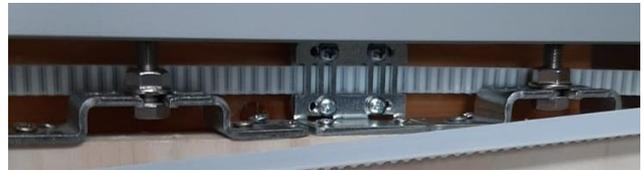
Befestigen Sie die Haken mit 6 Schrauben an den Laufkatzen, indem Sie die durch die Pfeile angezeigten Punkte beachten. Achten Sie darauf, das Teil mit der Ausfräsung zu montieren, dass es in der richtigen Richtung auf die Laufkatzen eingreift.
